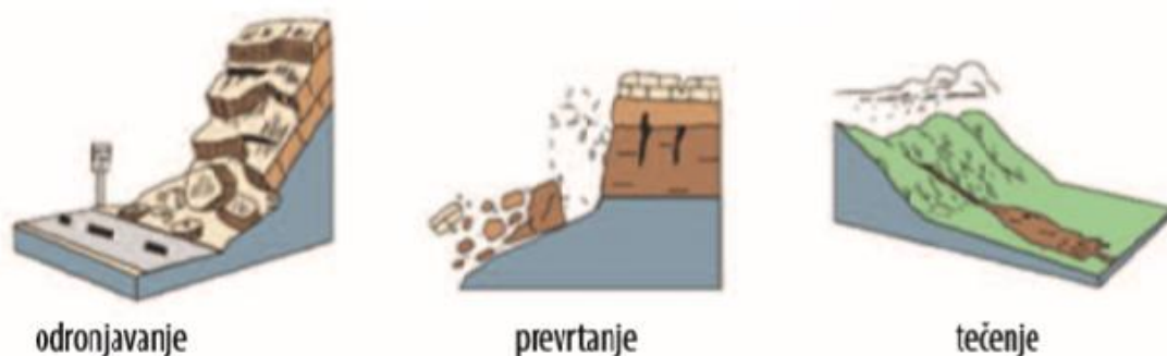
Slika 17: Prikaz osnovnih tipova klizanja prema mehanizmu kretanja
